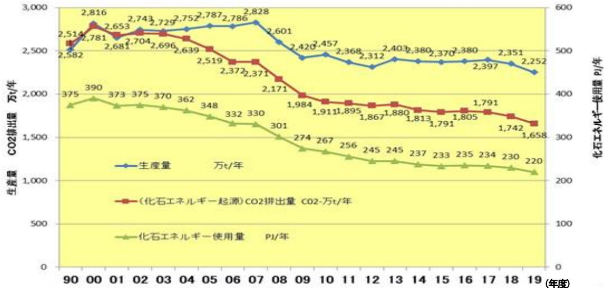
図12 生産量とCO 2 排出量および化石エネルギー使用量の推移
