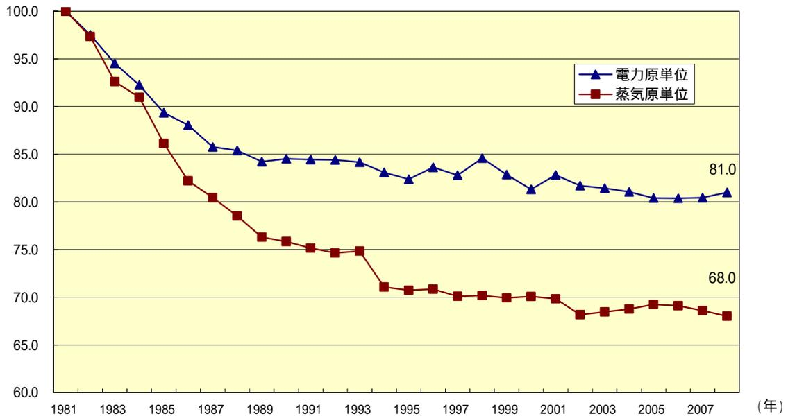
図 1 3 電力および蒸気消費原単位指数の推移(1981年=100)
