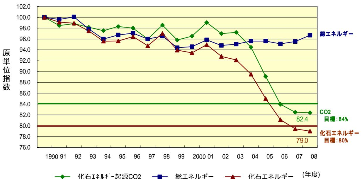
図3 化石エネルギー原単位指数およびCO<sub>2</sub>排出原単位指数の推移(1990年度=100)
