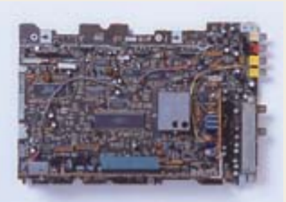
実際にビデオに使われているプリント配線板。下のこげ茶色の板の部分が紙です。
